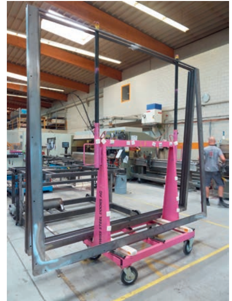
Hier beispielsweise mit ausgefahrenen Holmen und in Querrichtung stehenden Kranhakenlaschen. Ici avec les longerons sortis et des pattes de crochets de grue transversales.
