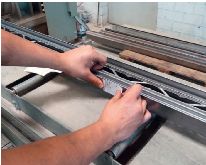
Im Zuge des Zuschnitts erhält das Profilrohr seinen Identifikationscode. Pendant la découpe, le tube profilé reçoit son code d'identification.
