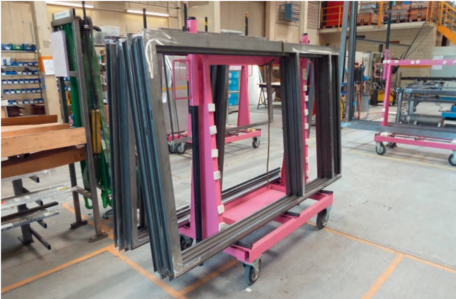
Für den Transport von Rahmen und Flügeln wurden gut sichtbare Fahrgestelle weiterentwickelt. Des châssis bien visibles ont été conçus pour le transport de cadres et de vantaux.
