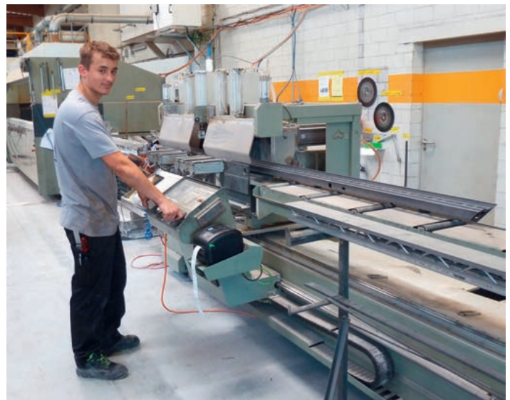
Jan Gutknecht beim Profilzuschnitt auf der Doppelgehrungssäge. Gleich anschliessend (hinten) das Profilbearbeitungscenter.
