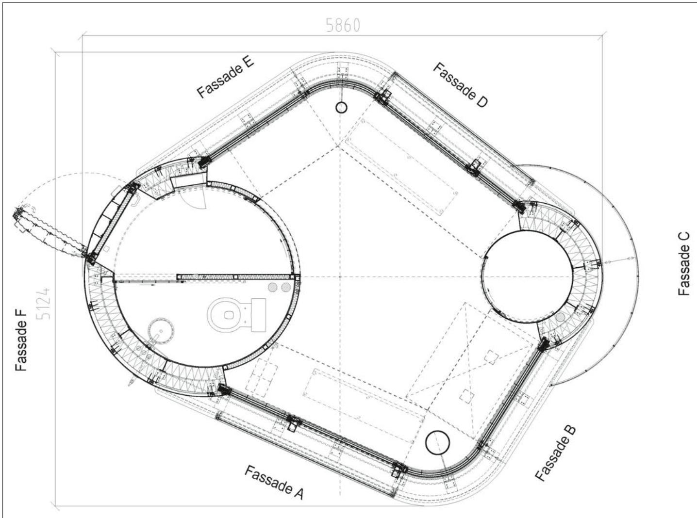
**Horizontalschnitt durch den verglasten Bereich:** Gut zu erkennen ist die Form einer verschobenen Raute mit den beiden Zylindern an den Spitzwinkeln. Links der grosse, zweigeteilte Zylinder mit Eingangstüre / Foyer und abgetrennter Toilette. Rechts im kleinen Zylinder der Umkleideraum. Dazwischen die Verglasungen mit gerundeten Ecken und Hubfenstern.
