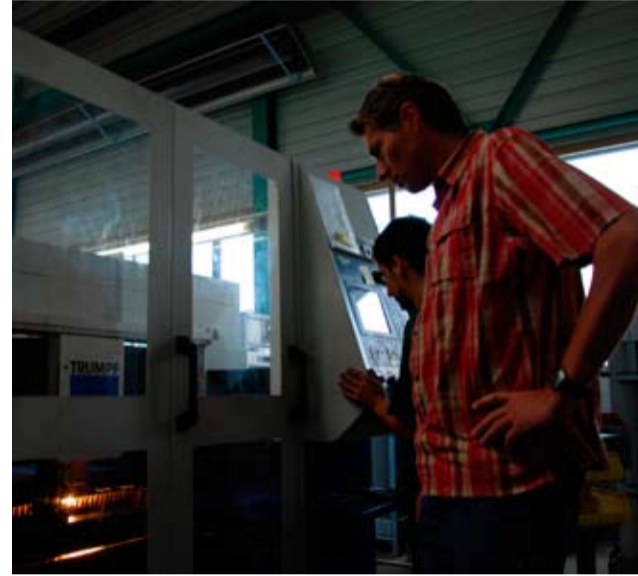
Geschäftsführer Heier Blaser schaut beim Zuschneiden der Stahlbleche mit der neuen Laserschneidmaschine zu. Bild Simon Jörgen
